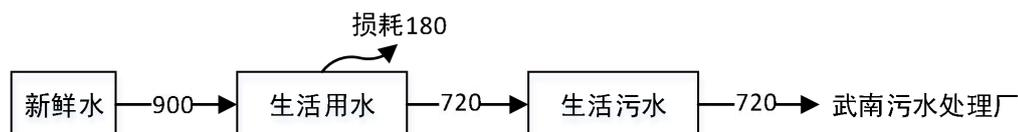
图 2-1 本项目实际水平衡图（t/a）
